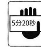
e) 停止: 抽吸过程中, 产品会自动进行抽吸口数计数。为保证烟支口感, 当抽吸口数大于16口时, 产品会终止加热 (此时指示灯会闪烁5次进行提示), 提示用户更换烟支。如果用户加热后一直不抽吸, 产品也会在5分20秒后自动停止加热, 进入待机状态。
