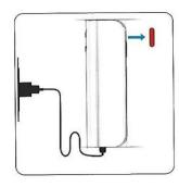
j). 充电: 待机时插入USB充电线, 红灯点亮 机器进入充电状态。充满电后, 红灯熄灭, 进入待机状态。
