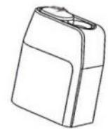
1.2연창보호뚜껑(사용시 연탄을 삽입부 일부분까지 삽입하고 가열후 연탄 피우신후 좌우로 돌리면서 연탄을 제품에서 분리시킵니다. 또한 손으로 보호뚜껑 위로 밀면서 연탄을 분리할수도 있습니다. 연창보호뚜껑과 제품본체는 자석으로 연결하여 쉽게 분리하고 연결할수 있습니다. 사용자안전을 위하여 제품 사용중에는 연창보호뚜껑 분리삼가하시기 바랍니다.)
