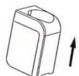
1.4 发热棒 (采用的氧化铝陶瓷材质, 发热时温度达到300多度, 在加热工作中禁止打开烟舱保护罩, 忌用锋利物件摩擦碰撞, 以免损害物件。如要清洁请冷却后在打开)
