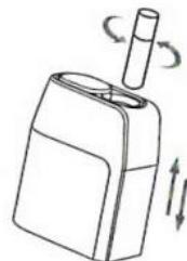
1.3 発熱棒の保護カバー（特殊なPEEKの高温の材料を使う。使っている時、内部に高温があるので、発熱棒の保護カバーを開けないでください。発熱棒を清掃すれば、冷却した後に指で発熱棒の保護カバーを挟んで上に引き抜いてください）
