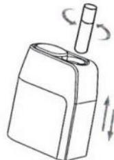
1.3 发热棒保护罩(采用特殊PEEK高温材料, 使用时内高温禁止打开, 如要清洁发热棒等冷却后用手指夹住往上抽动即可)
