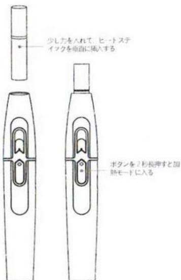
図3 ヒートスティックの挿入及び起動
