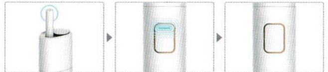
일반 권련을 사용하는 것과 동일하게 필터부위를 물고 천천히 사용하십시오. (4분 동안 사용가능) 종료 30초 전 진동이 발생하며 진동 후 종료 시점까지 상태 LED가 아이스블루색 으로 점멸합니다. 사용시간이 종료되면 자동으로 상태 LED가 꺼지며 작동이 종료됩니다.
