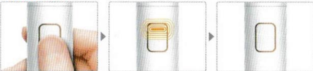
기기의 작동버튼을 빠르게 5회 눌러주세요. (2초 내 5회) 상태 LED가 오렌지색 으로 90초간 점멸하며 자동으로 청소가 진행됩니다. 청소가 종료되면 자동으로 상태 LED가 꺼지며 진동이 2회 발생합니다.
